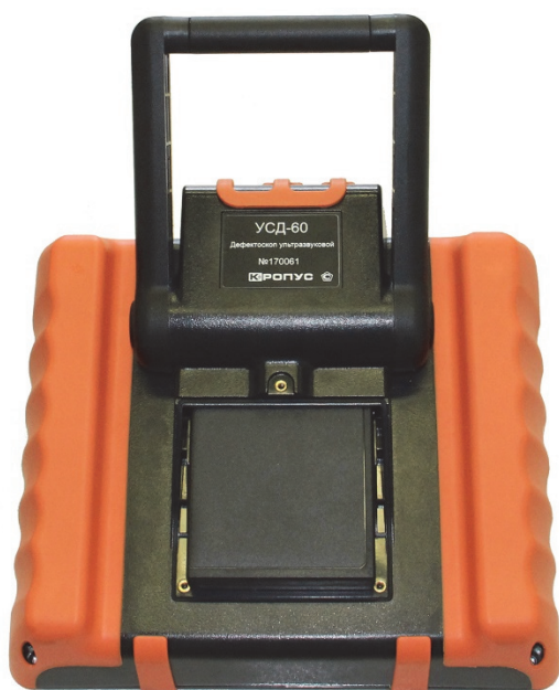
Рис. 1-2 Прибор со снятой крышкой аккумуляторного отсека
