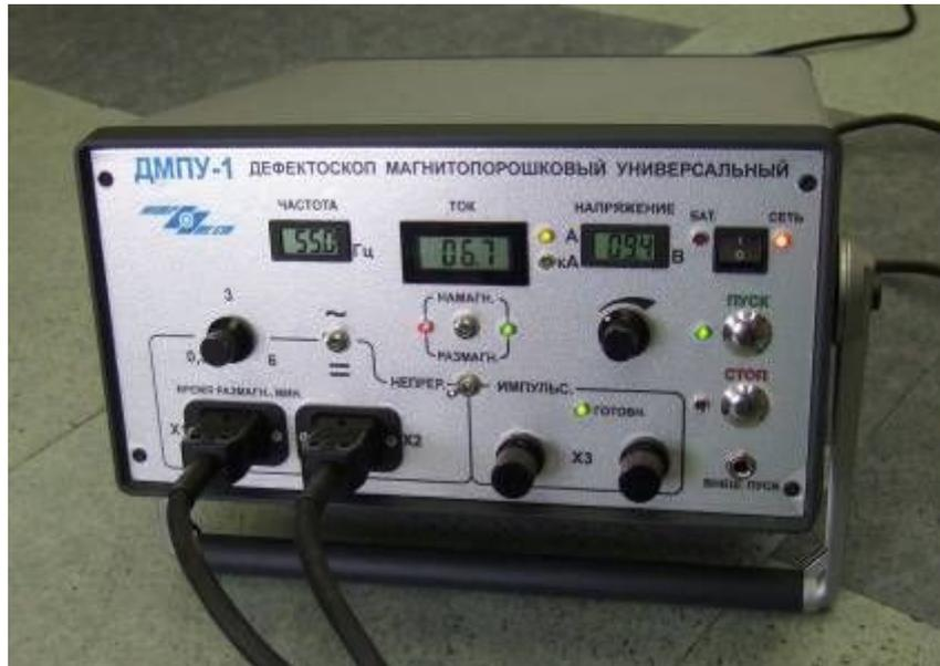
Рисунок 1 –Электронный блок дефектоскопа
