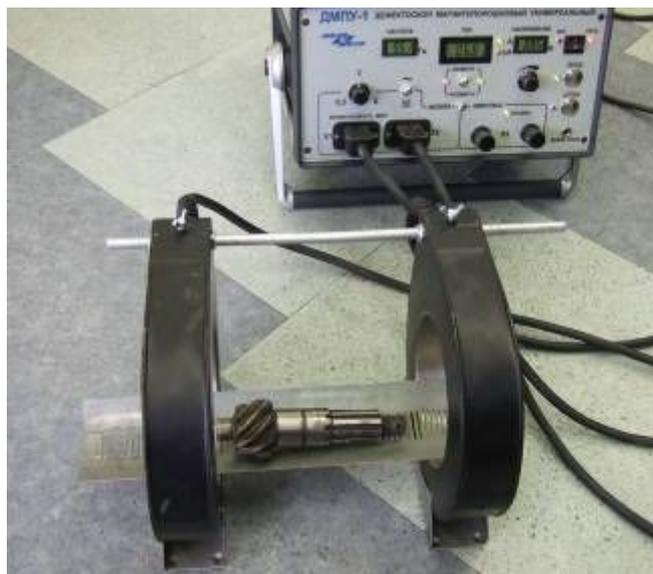
Рисунок 2 – Катушки намагничивания
