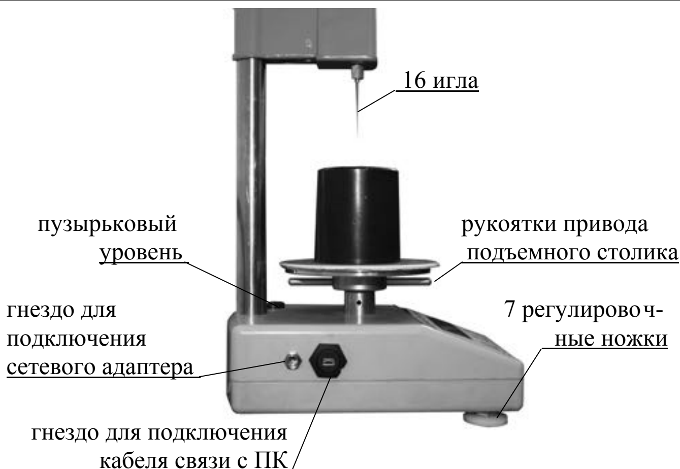
Рисунок 2 - Вид левой боковой панели прибора АПН-360МГ4
